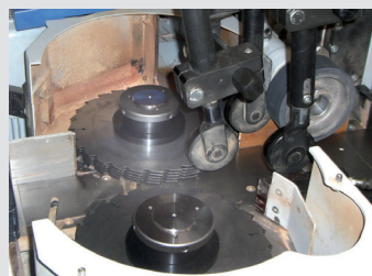
Dünnschnitt-Kreissägeblatt-Satz in einer Spaltanlage
