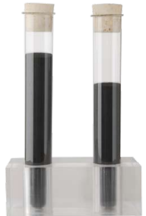
Für das EcoKnife wird weniger Hartmetallpulver benötigt. Links: Hartmetalleinsatz Standard-Wendeplatte. Rechts: Hartmetalleinsatz EcoKnife
