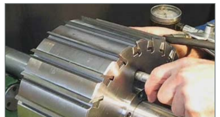
Flinker Messerwechsel dank dem Schnellspannsystem
