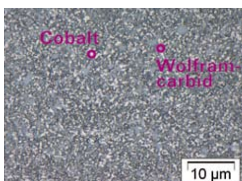
Zusammensetzung von Hartmetall – das Verhältnis Cobalt : Wolframcarbid und die jeweilige Korngröße variieren je Hartmetallsorte.
